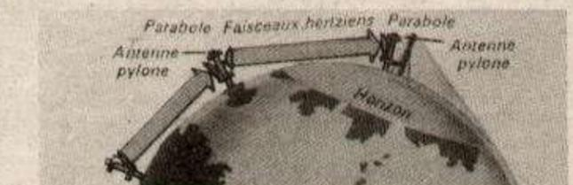
A partir des très hautes fréquences (supérieur à 30MHZ), on peut utiliser les ondes sous forme de faisceaux qui se propagent à vue. D'où le nom d'autoroute des ondes donné aux faisceaux hertziens. Les relais sont espacés en moyenne de 40 à 50km. Les faisceaux hertziens à micro-ondes ont une très grande fréquence leur permettant de transporter une quantité colossale de messages : conversations téléphoniques, canaux de TV, radios...
